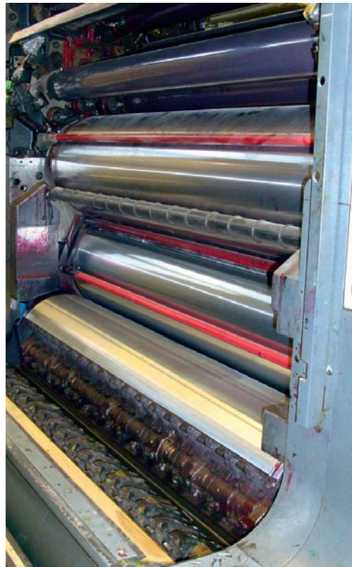
Die Abbildung zeigt einen Druckzylinder in einem beschädigten Druckwerk.
